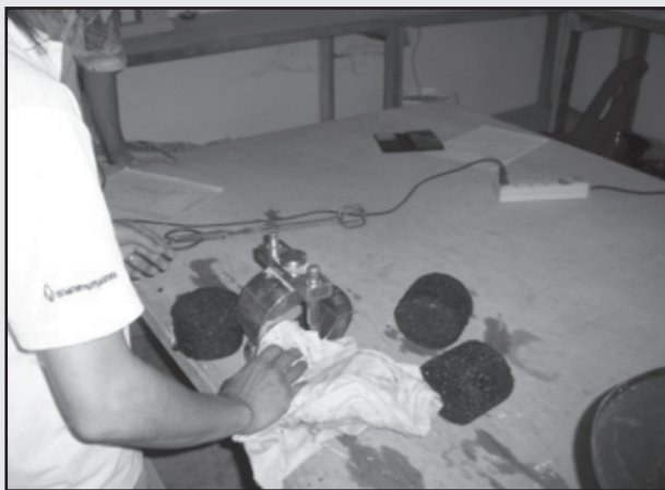
รูปที่ 3-15 แสดงการหาค่า Density Stability &amp; Flow
