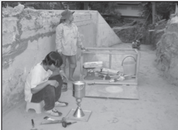
รูปที่ 4-22 การทดสอบความแน่น โดยวิธี Sand Cone Test
