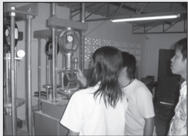
รูปที่ 3-15 แสดงการหาค่า Density Stability &amp; Flow
