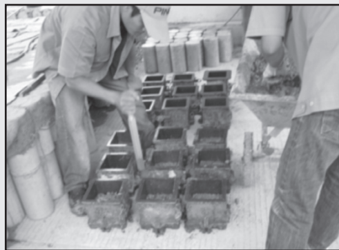
รูปที่ 3-19 การเก็บตัวอย่างคอนกรีตเพื่อทดสอบหาค่ากำลังอัดประลัย
