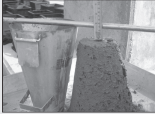
รูปที่ 3-18 การตรวจสอบค่าการยุบตัว (Slump Test)
