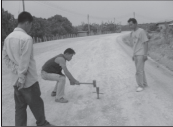
รูปที่ 4-35 การใช้เหล็กเจาะ เพื่อตรวจสอบความหนาชั้นวัสดุ
