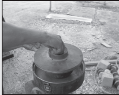
รูปที่ 3-13 แสดงการหาปริมาณยาง Asphalt Cement
