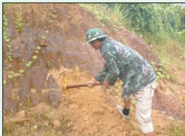
รูปที่ 4-42 การเก็บตัวอย่างวัสดุจากแหล่งส่งทดสอบในห้องปฏิบัติการ
