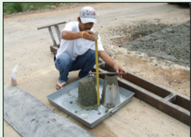
รูปที่ 6-56 ตรวจสอบความชื้นเหลือทันทีที่รถลำเลียงมาถึง
