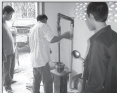
รูปที่ 3-14 แสดงการทำก้อนตัวอย่าง เพื่อหาค่า Density Stability &amp; Flow
