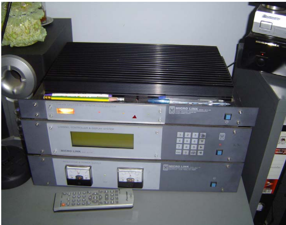
ภาพที่ 3.2 ก เครื่องส่งสัญญาณ เครื่องควบคุมการออกอากาศ และ เครื่องจ่ายไฟ ของหอกระจายข่าวแบบไร้สายอัตโนมัติ
